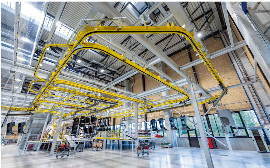
Vor den Pulverkabinen befindet sich ein Querpuffer und der Maskierungsbereich.
