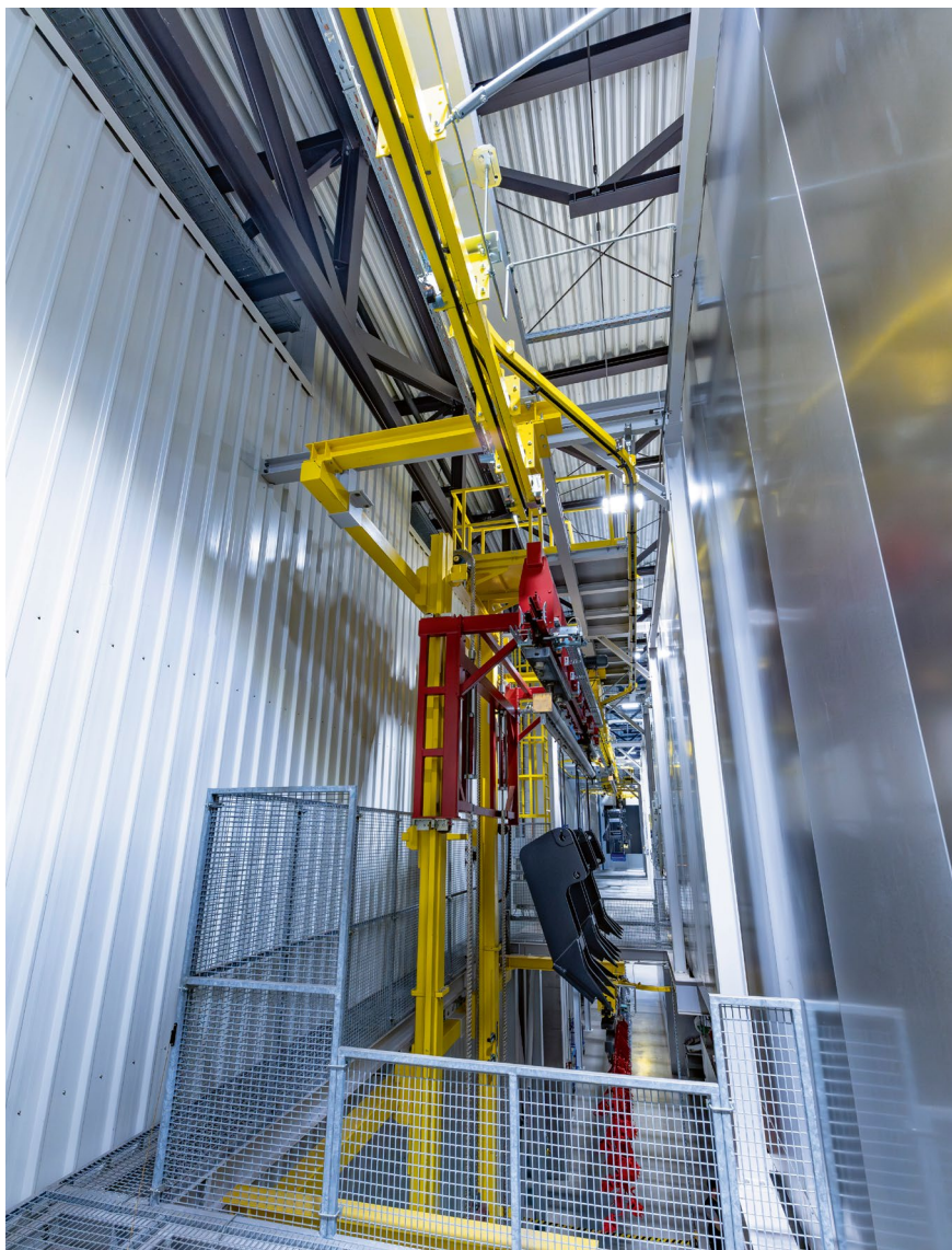
Der geführte Etagenheber transportiert die Laufwagen vom OG ins EG.
