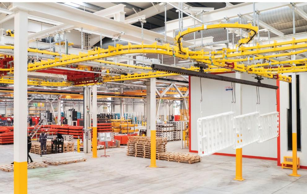
**Bild 3** > Ausfahrt aus dem Pulvereinbrennofen mit anschließender Kühlstrecke.
