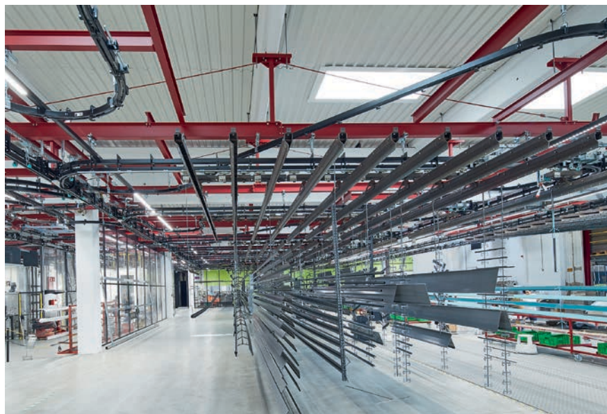
Bild 3 > Abkühlplätze nach dem Pulvereinbrennofen mit verglaster Einhausung des Pulverbereichs links und dem Abgabebereich rechts.
